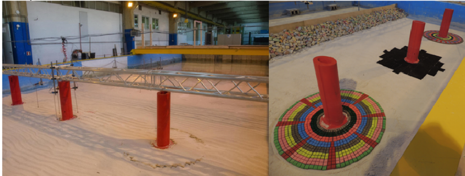
Figura 1. Izda.: Vista general del TOD desde el fondo de la instalación. Dcha.: Detalle de la protección de las pilas para una de las configuraciones de ensayo.
