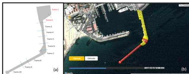
*Figura 2 Tramificación del dique Sagrado Corazón (a) y salida del Sistema Operacional de Rebases (b).*
