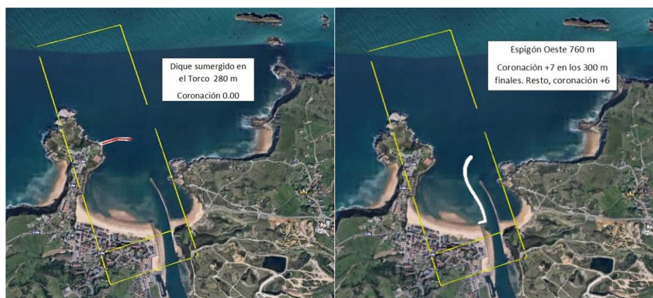
Fig. 2. Configuraciones ensayadas (además de la situación actual). Izquierda, Configuración 1 y derecha, Configuración 2. En el recuadro amarillo, contorno del tanque de ensayos a escala 1/100.
