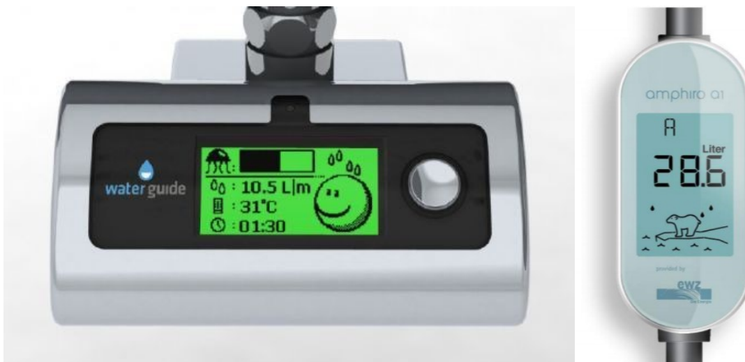
Figure 2.13 Appareil WaterGuide (gauche) et Amphiro a1 (droite) (tiré de : Aarestrup, 2012, 17 octobre; Tiefenbeck et al., 2014)
