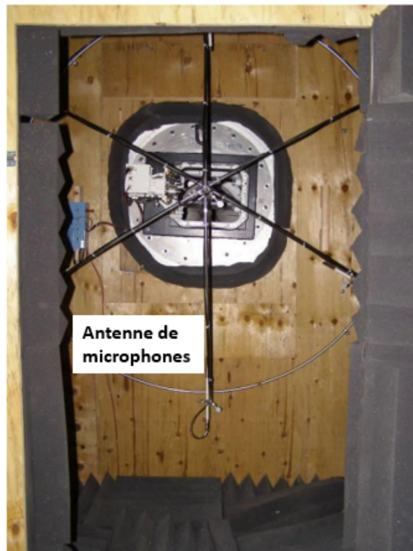
Figure 2.26 Antenne de microphones installée en aval de la vanne de Shin et al. [86]
