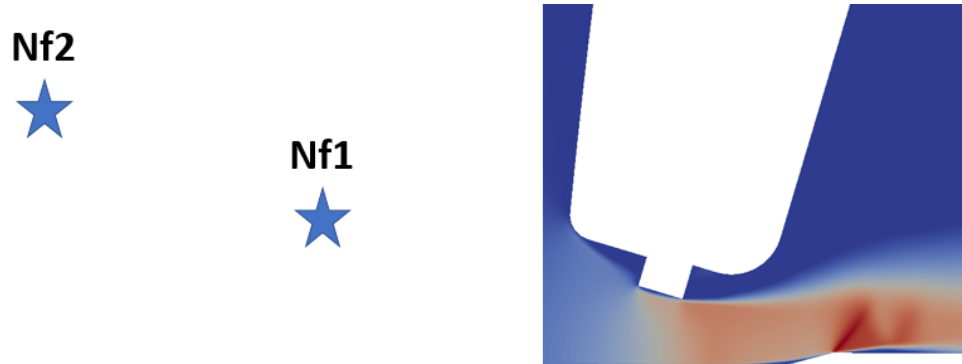
Figure 6.31 Position des sondes en champ proche en amont de la lèvre supérieure
