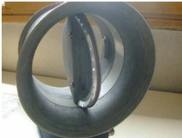
Figure 1.2 Un exemple de vanne papillon de pressurisation de cabine d'avion [42]
