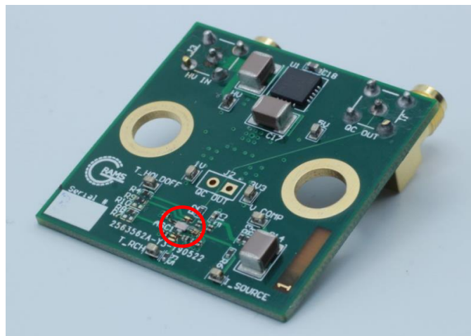
Figure 1.3 Module de détection monophotonique possédant une précision de 10 ps LMH qui nécessite seulement une alimentation de 10 V et qui possède une sortie SMA 50 ohms.
