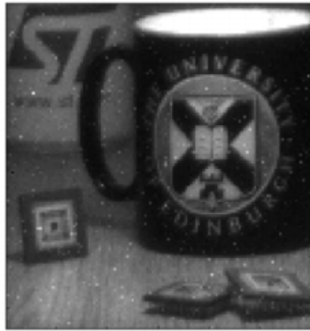
Figure 2.11 Image en ton de gris provenant d'un détecteur à base de SPAD illuminé en face arrière sans traitement post-acquisition. L'image provient d'une seule acquisition et les points blancs représentent des pixels avec fort bruit d'obscurité [3].
