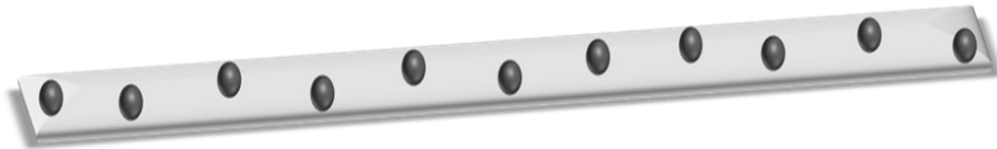
Figure 25. Structure du photocatalyseur plasmonique à base de nanoceintures de TiO 2 sur lequel est adsorbé des NPs de TiN décoré de façon homogène.
