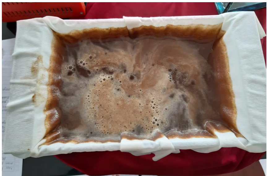
Proses Penyaringan air yang memisahkan flok dan koagulan
