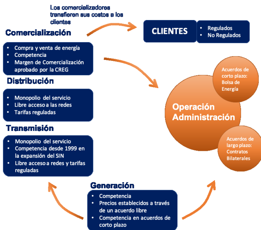
Figura 2. Estructura de mercado del sistema eléctrico colombiano
