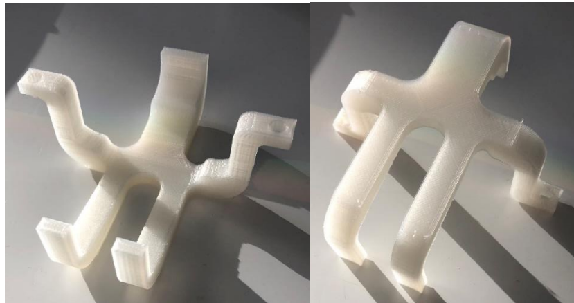
Figura 29: Primer prototipo pieza "abrazadera" impresa 3D
