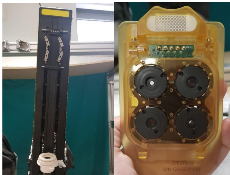
Figura 7: Mecanismo interfaz brazo robótico/Herramienta EndoWrist
