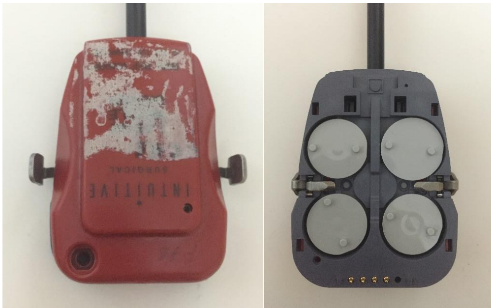
Figura 4: Porta Agujas - Mecanismo de articulaciones
