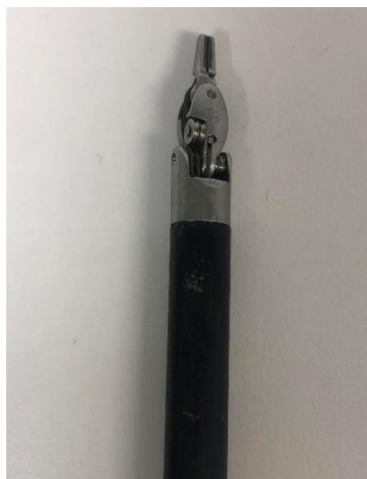
Figura 42: Posición de reposo del Instrumento EndoWrist
