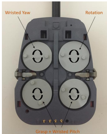
Figura 8: Mecanismos de giro de la herramienta EndoWrist
