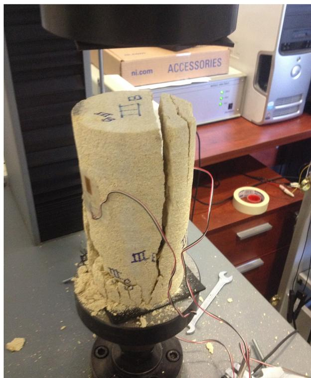
Ilustración 64. Rotura de probeta III B.
