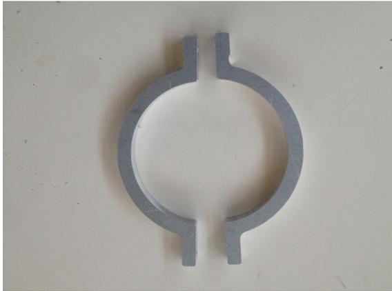
Ilustración 10. Piezas 3 y 4 del conjunto extensómetro.
