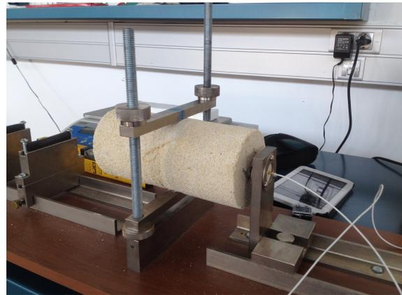
Ilustración 22. Disposición de probeta para obtención de módulo de elasticidad longitudinal en ensayo dinámico.
