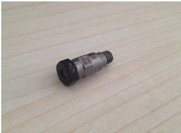
Ilustración 17. Acelerómetro de equipo de ensayo dinámico
