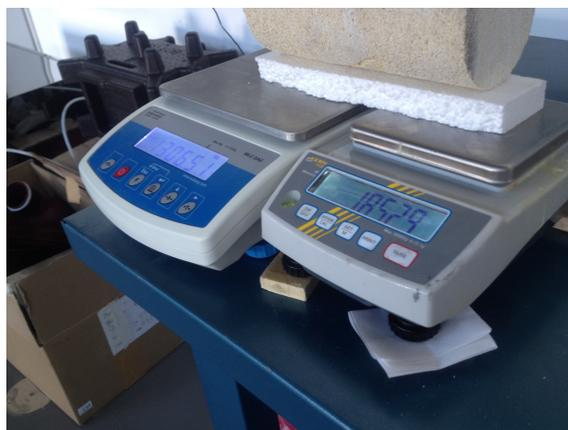
Ilustración 20. Pesado de probeta con doble balanza.
