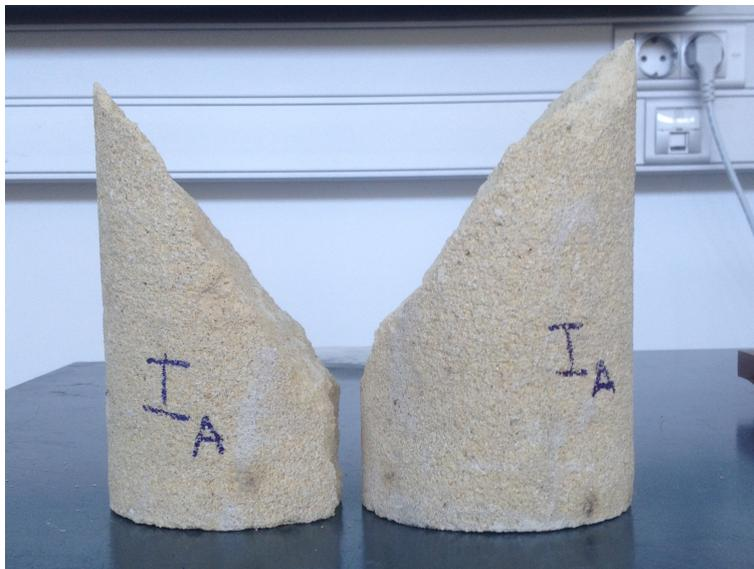
Ilustración 36. Rotura de probeta IA.
