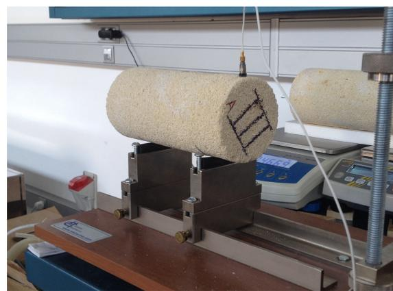
Ilustración 24. Disposición de probeta para ensayo dinámico transversal.
