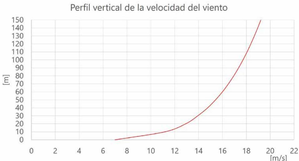
Figura 5. Perfil vertical de la velocidad del viento. Modelo logarítmico.
