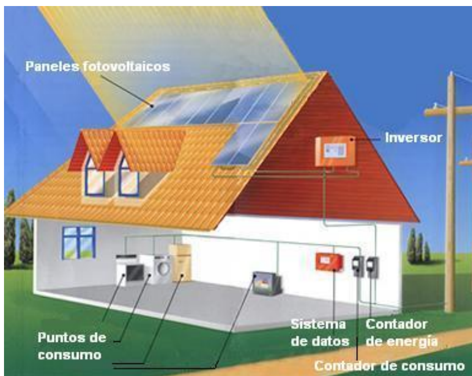
Figura 14. Descripción del proceso de paneles fotovoltaicos.
