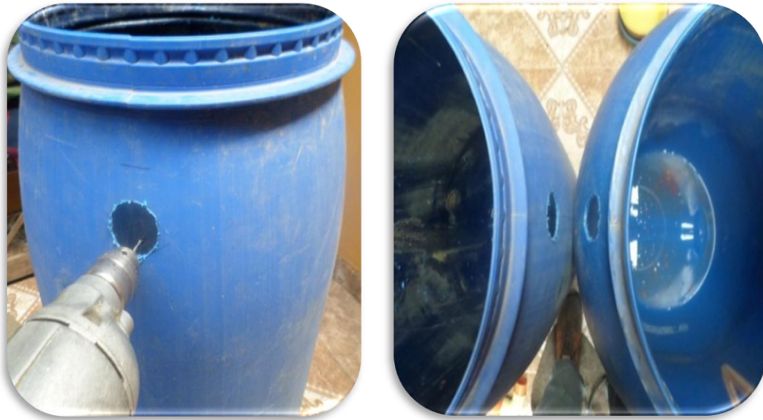
Imagen 18 Adaptación de los tanques
