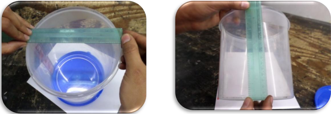
Imagen 20 Elaboración del pluviómetro
