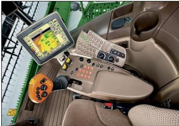
Figura 8. Monitor de Rendimiento En Cosechadora John Deere
