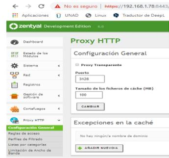
Fig. 22. Configuración general del proxy
