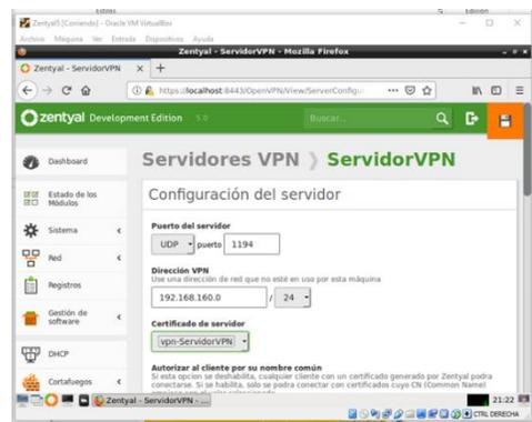
Fig. 55. Configuración del servicio VPN creado
