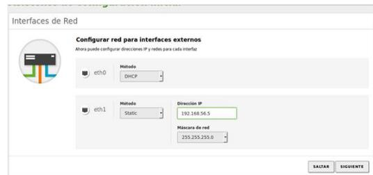
Fig. 44. Configuración ip estática
