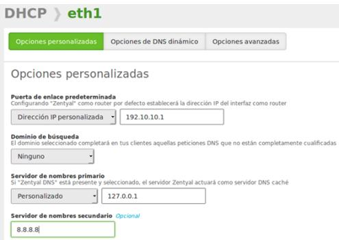
Fig. 14. Configuración de la puerta de enlace en el DHCP
