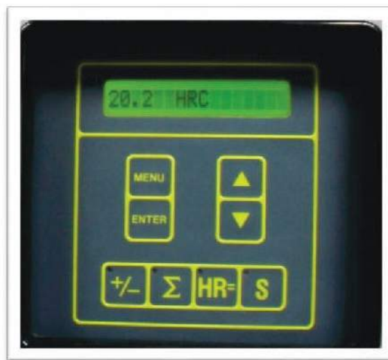
Figura 16. Numero de corrida 2, Probeta de 0,30 % Carbono. Dureza de 20,2 HRC.
