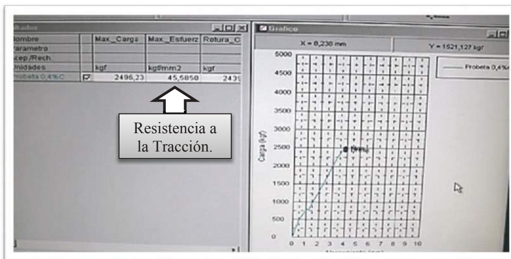
Figura 11. Numero de corrida 11, Probeta de 0,40 % Carbono, Resistencia a la Tracción obtenida de 45,58 Kgf/mm 2
