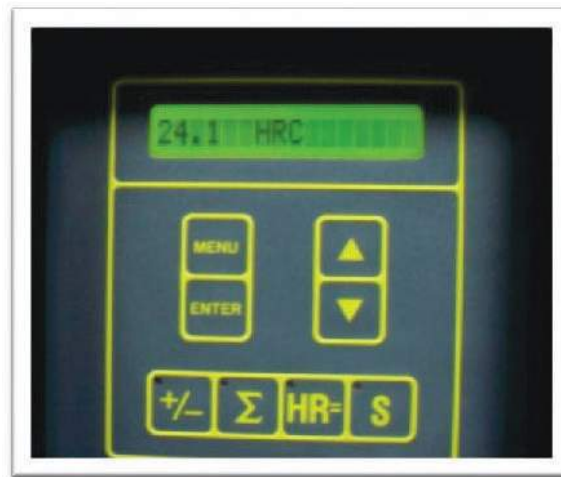
Figura 17. Numero de corrida 6, Probeta de 0,35 % Carbono. Dureza de 24,1 HRC.
