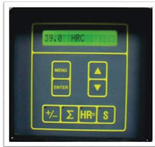
Figura 19. Numero de corrida 18, Probeta de 0,45 % Carbono. Dureza de 39,0 HRC.
