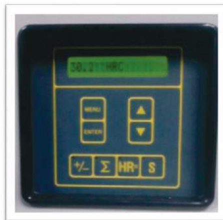
Figura 7. Dureza primera toma diente original 30,2 en escala Rockwell C.
