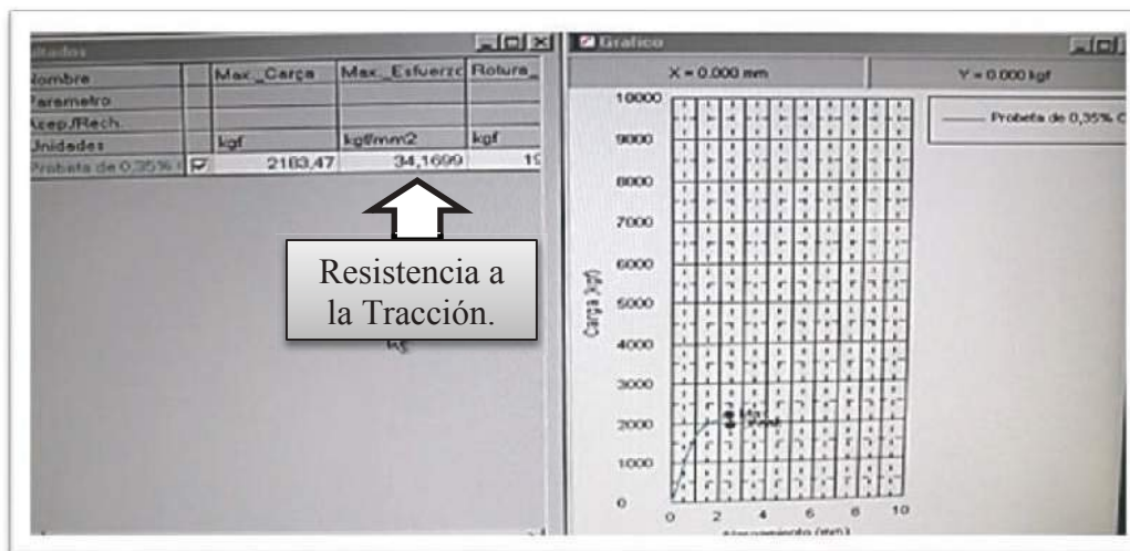
Figura 10. Numero de corrida 8, Probeta de 0,35 % Carbono, Resistencia a la Tracción obtenida de 34,16 Kgf/mm 2
