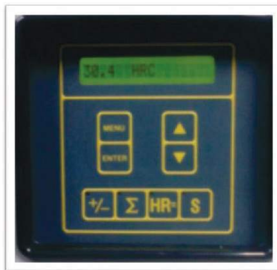
Figura 18. Numero de corrida 12, Probeta de 0,4 % Carbono. Dureza de 30,4 HRC.
