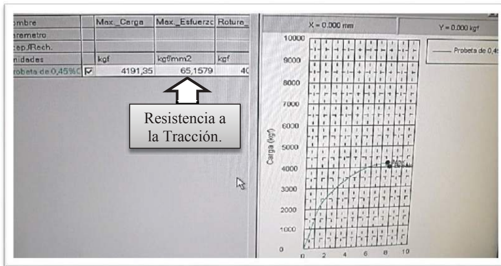
Figura 12. Numero de corrida 17, Probeta de 0,45 % Carbono. Resistencia a la Tracción obtenida de 65,15 Kgf/mm 2
