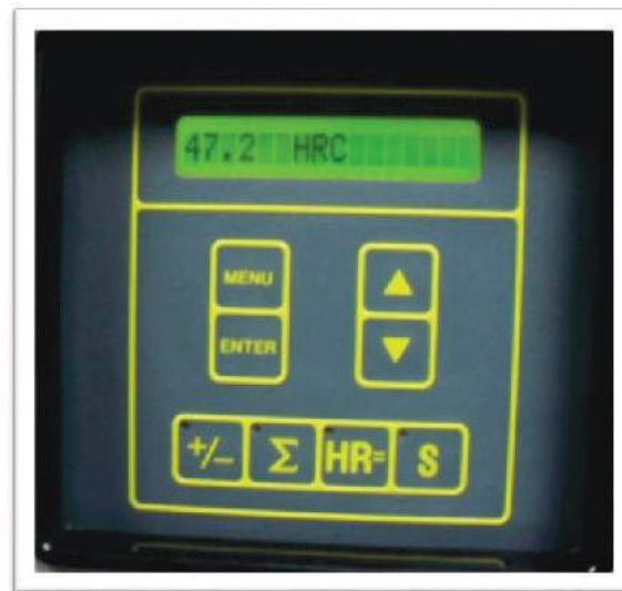
Figura 20. Numero de corrida 24, Probeta de 0,5 % Carbono. Dureza de 47,2 HRC.
