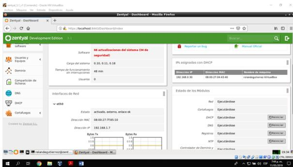
Figura 13. Asignación de la dirección IP por medio del DHCP en zentyal.
