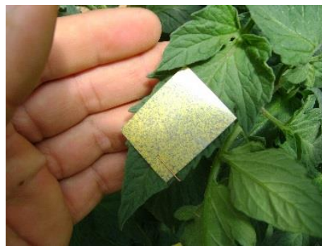
Figura 8. Evaluación tamaño de gota, uniformidad de la aplicación, utilizando papel hidrosensible. Fuente: (Pérez, 2019)
