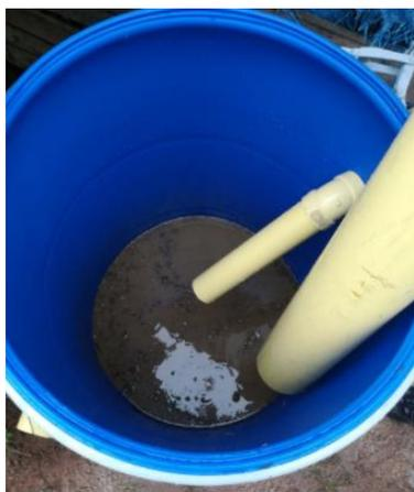
*Figura 39. Llenado biodigestor con el sustrato. "Elaboración propia".*
