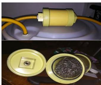
*Figura 37. Instalación trampa ácido sulfhídrico. "Elaboración propia".*
