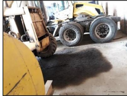
Ilustración 39. Derrames provenientes de maquinaria.
