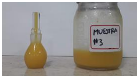
Figura 5-10 Determinación de densidad con picnómetro 7 mL.
