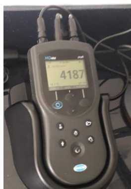
Figura 5-9 Medidor potenciométrico de pH HACH multiparámetro HQ40d
