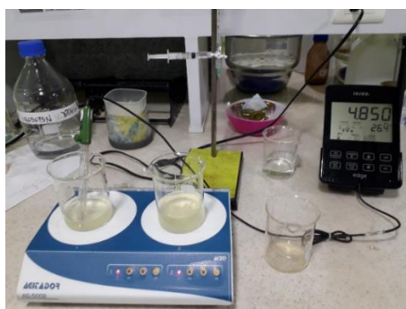
Figura 5-14 Montaje de pH estático para la determinación de la pectinesterasa.
