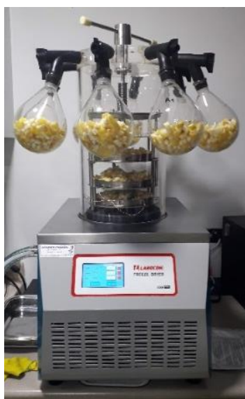
Figura 5-15 Montaje del Liofilizador con cascara Passiflora Edulis Flavicarpa .
