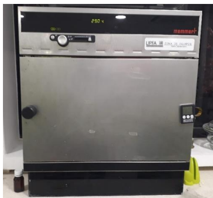
Figura 5-5 Horno de secado MEMMERT GmbH+Co Kg UNB 200.
