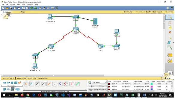
f. Las estaciones de trabajo en las LAN de MEDELLIN y CALI no deben tener acceso a ningún dispositivo fuera de su subred, excepto para interconectar con el servidor.
