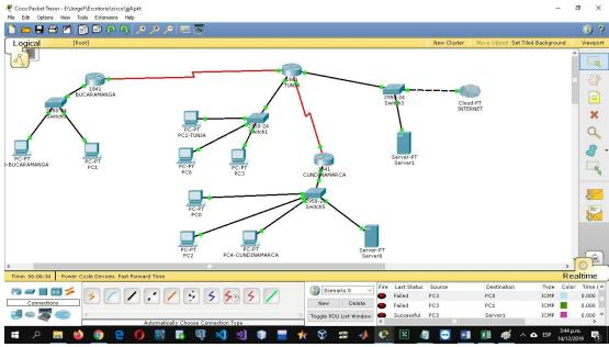
6. VLSM: utilizar la dirección 172.31.0.0 /18 para el direccionamiento. Se realiza la tabla de enrutamiento VLSM teniendo en cuenta la dirección dada
