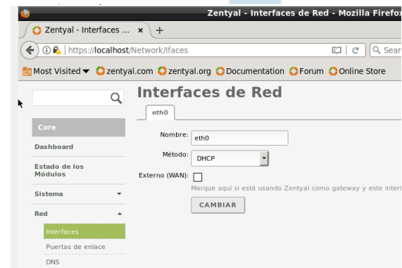
Fig. 20 configuración interfaces de red
