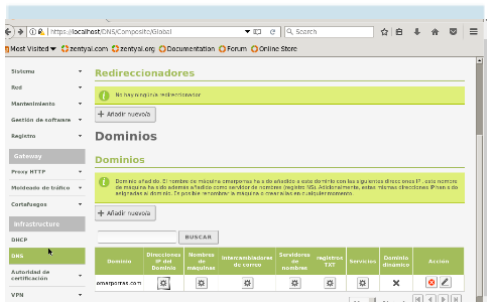
Fig. 28 configuración del dominio DNS
