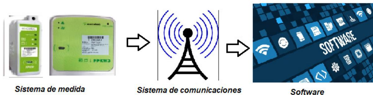
Figura 7 Componentes del sistema AMI
