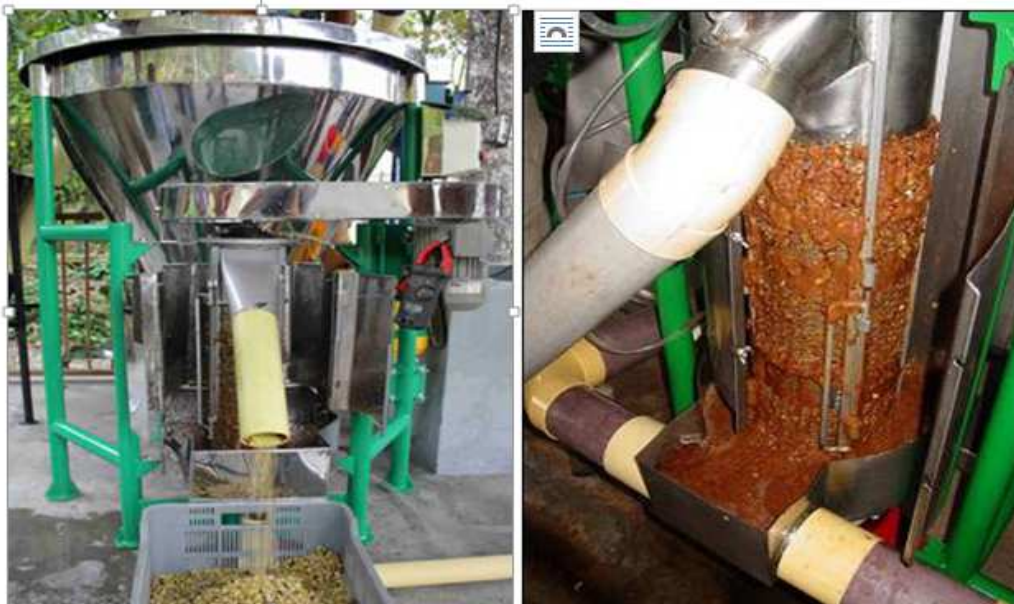
FIGURA 44. Ecomill descargando café desmielado y proceso del desmucilagado
