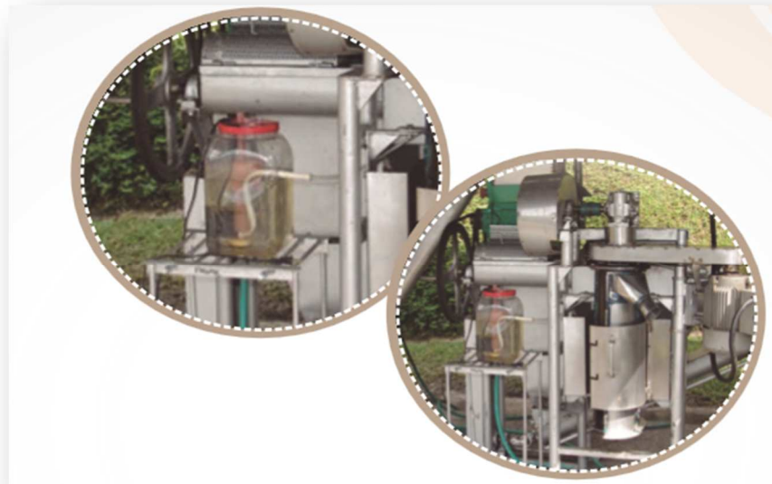
Figura 36. Adaptación de flotador y bomba sumergible
