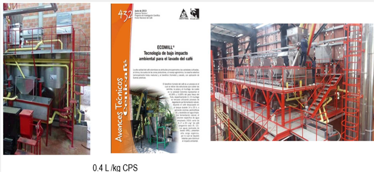
Figura 43. Equipos con consumo de 1/de agua por. Km CPS beneficiado Fuente (OLIVEROS T., SANZ U., RAMIREZ G., & TIBADUIZA V., 2013)
