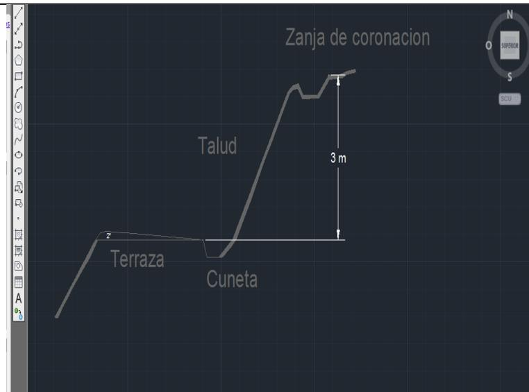
Imagen No. 40 Drenaje en terrazas. (Fuente; Autocad y El Autor).
