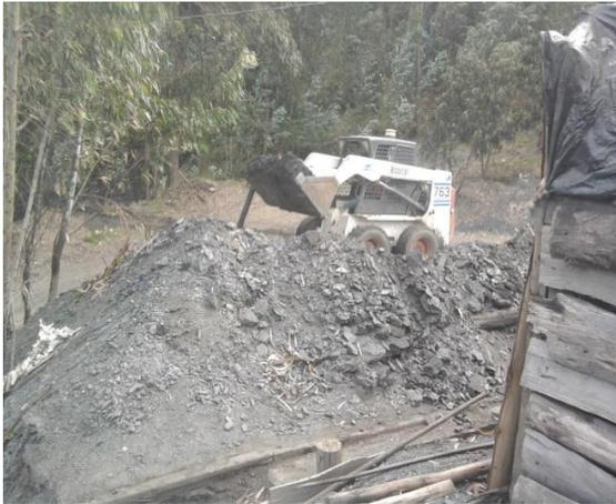
Imagen No. 11 Almacenamiento depósito de estériles en superficie. (Fuente; El Autor)
