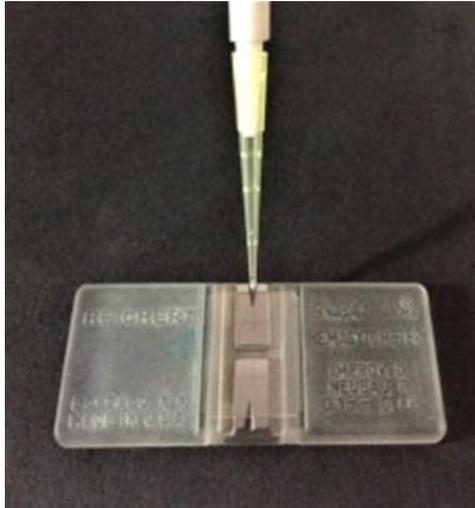
Prueba de germinación de esporas: Esta prueba establece el porcentaje de germinación de las esporas del hongo en un tiempo determinado.
