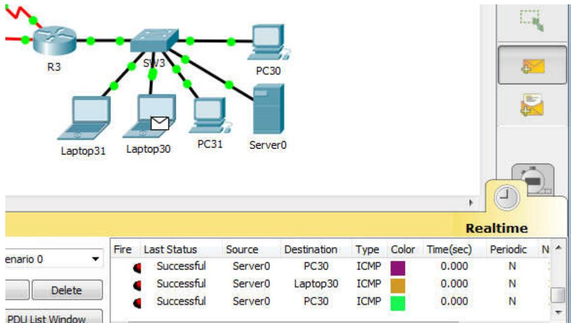
**10. La NIC instalado en direcciones IPv4 e IPv6 de Laptop30, de Laptop31, de PC30 y obligación de configurados PC31 simultáneas (dual-stack). Las direcciones se deben configurar mediante DHCP y DHCPv6.**
