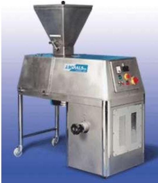
El molino B-160-V de Bonals está diseñado para el pulverizado y granulado de productos secos y húmedos. Su uso está destinado a los sectores químico-farmacéutico, alimentación (pastelería, vegetales, hortalizas y frutas), etc.
