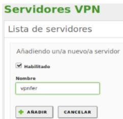
Figura 62. Creación de servidor VPN
