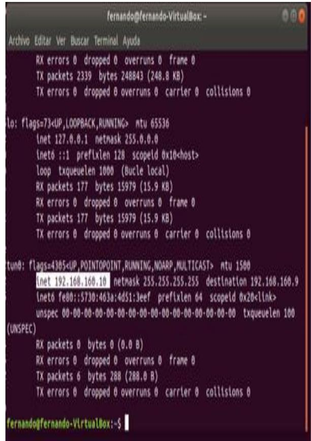
Figura 75. ip asignada por el servidor vpn
