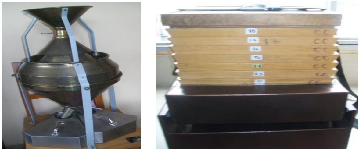
Fotografía 9. Homogenización y granulometría del café almendra.
