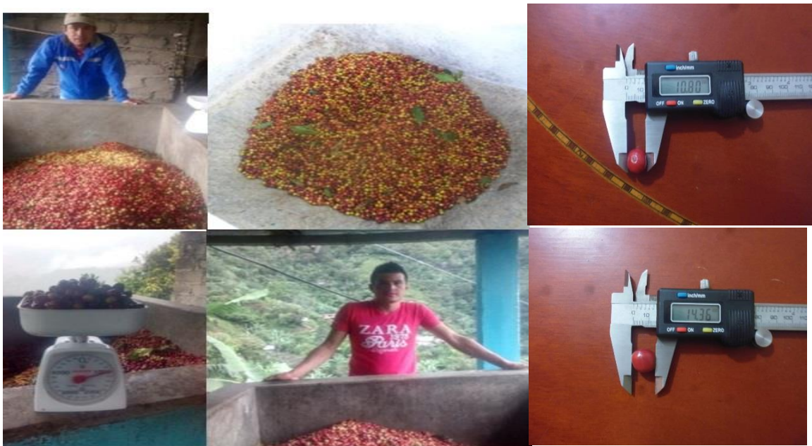
Fotografía 3. Recepción del café cereza en tolva – Medición diámetros
