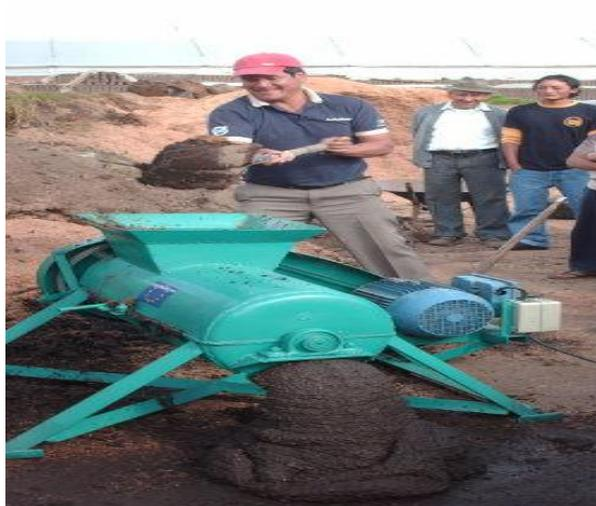
Figura 7. Molino mezclador con motor
