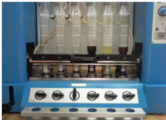
Figura 36. Evacuación de S.D.A. en el proceso de extracción de fibra cruda en las muestras de café de estudio.
