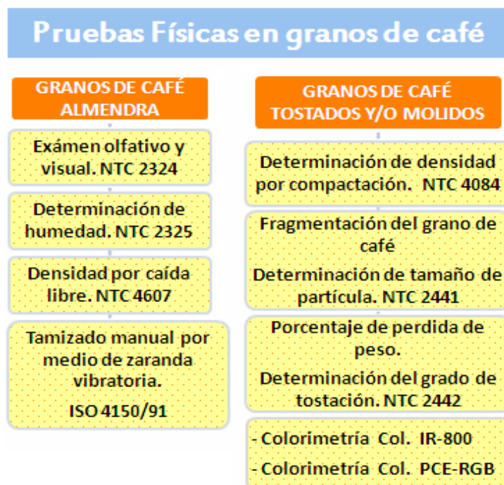
Figura 18. Pruebas físicas en café tostado y molido. Zona 1: La Unión y Zona 2: Buesaco
