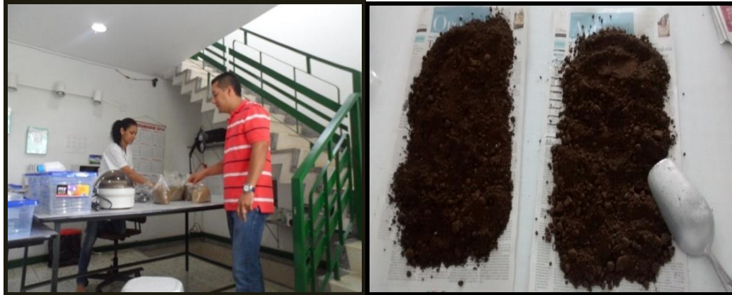
Figura 1. Procesamiento y secado de muestras de suelo.
