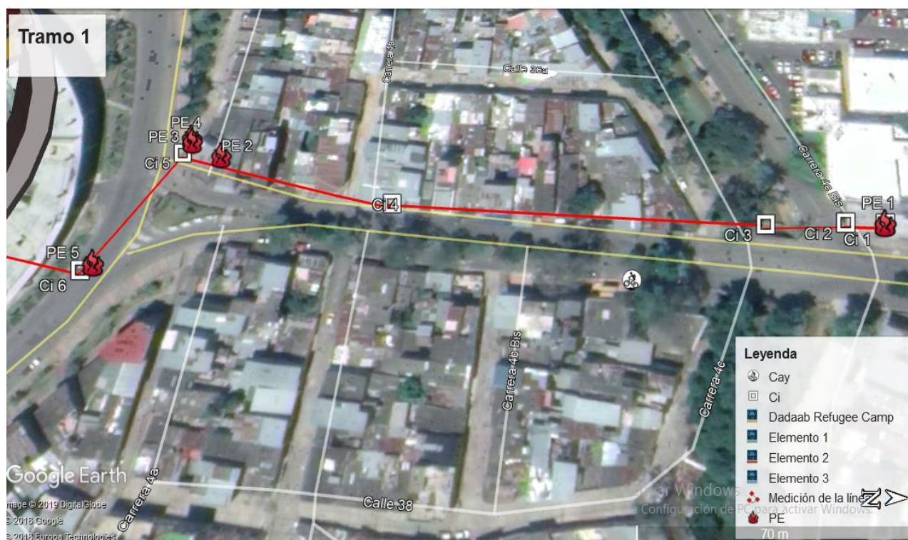
Figura 10. Tramo 1 Red de Alcantarillado Conectado al Hospital Federico Lleras Acosta. Fuente: Google Earth. (2019) Red de Alcantarillado. Ibagué. Colombia
