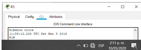
Figura 8. Verificación de clock de R1
