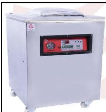
*Fuente: Máquina utilizada en el proceso de empaque al vacío, suministrado por la empresa BIOANBAY S.A.S*
