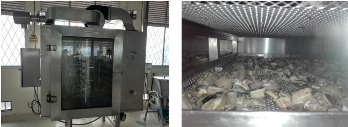
**Figura 7.** Deshidratación de residuos de pescado en deshidratador por convección. Fuente: los autores (2019)
