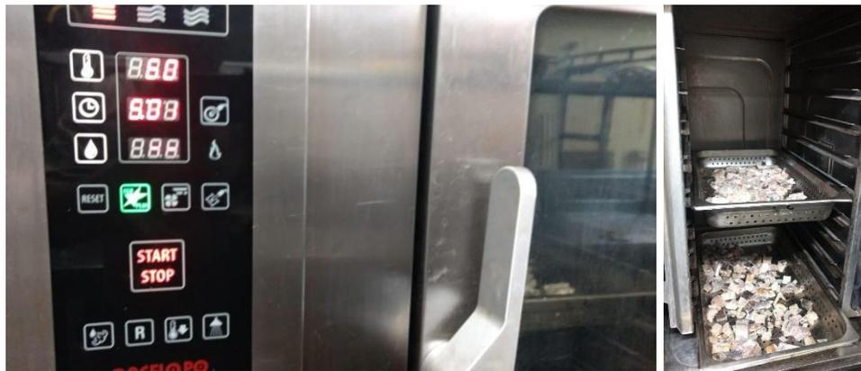
**Figura 8.** Deshidratación de residuos de pescado en horno combinado Rational. Fuente: los autores (2019)
