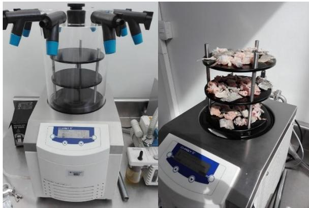
**Figura 5.** Deshidratación de residuos de pescado por liofilización. Fuente: los autores (2019)
