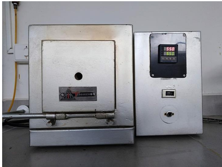
Ilustración 13 Proceso de incineración carbones activados
