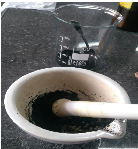
Ilustración 10 Maceración del carbón.
