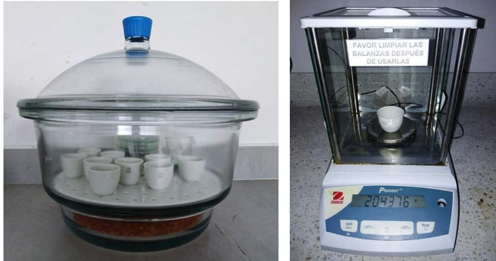
Ilustración 12 Reposo y determinación del peso del crisol vacío
