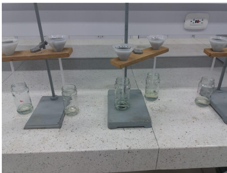
Ilustración 22 Filtración por gravedad
