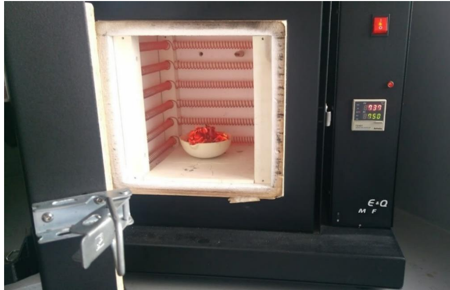
Ilustración 9 Proceso de carbonización.
