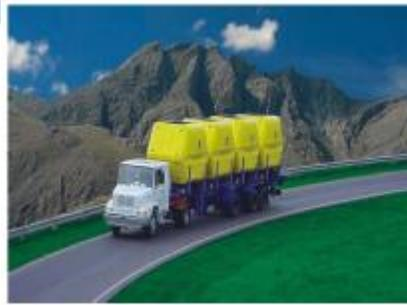
2. **Usando Gas Natural Licuefactado (GNL):** Para este sistema de transporte se replica lo indicado en el caso buques metaneros, debido a que se enfría el Gas Natural a  $-161^{\circ}\text{C}$ , convirtiéndolo en líquido (GNL) y reduciendo en 600 veces su volumen.<sup>11</sup>
