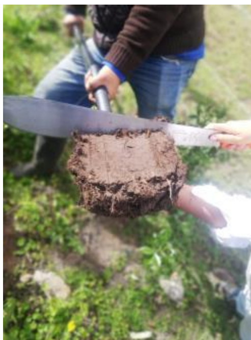
Foto 4. Eliminación del exceso de suelo para conformar la muestra de suelo. Fuente: Autor
