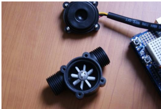
Figura 16. Sensor de caudal Arduino YF-s201
