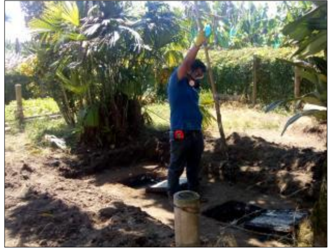
Foto 6 y 7. Medición cantidad de lodos a tratar
