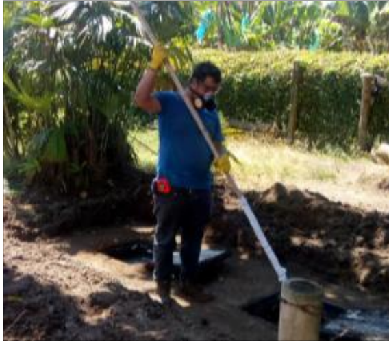
Foto 6 y 7. Medición cantidad de lodos a tratar
