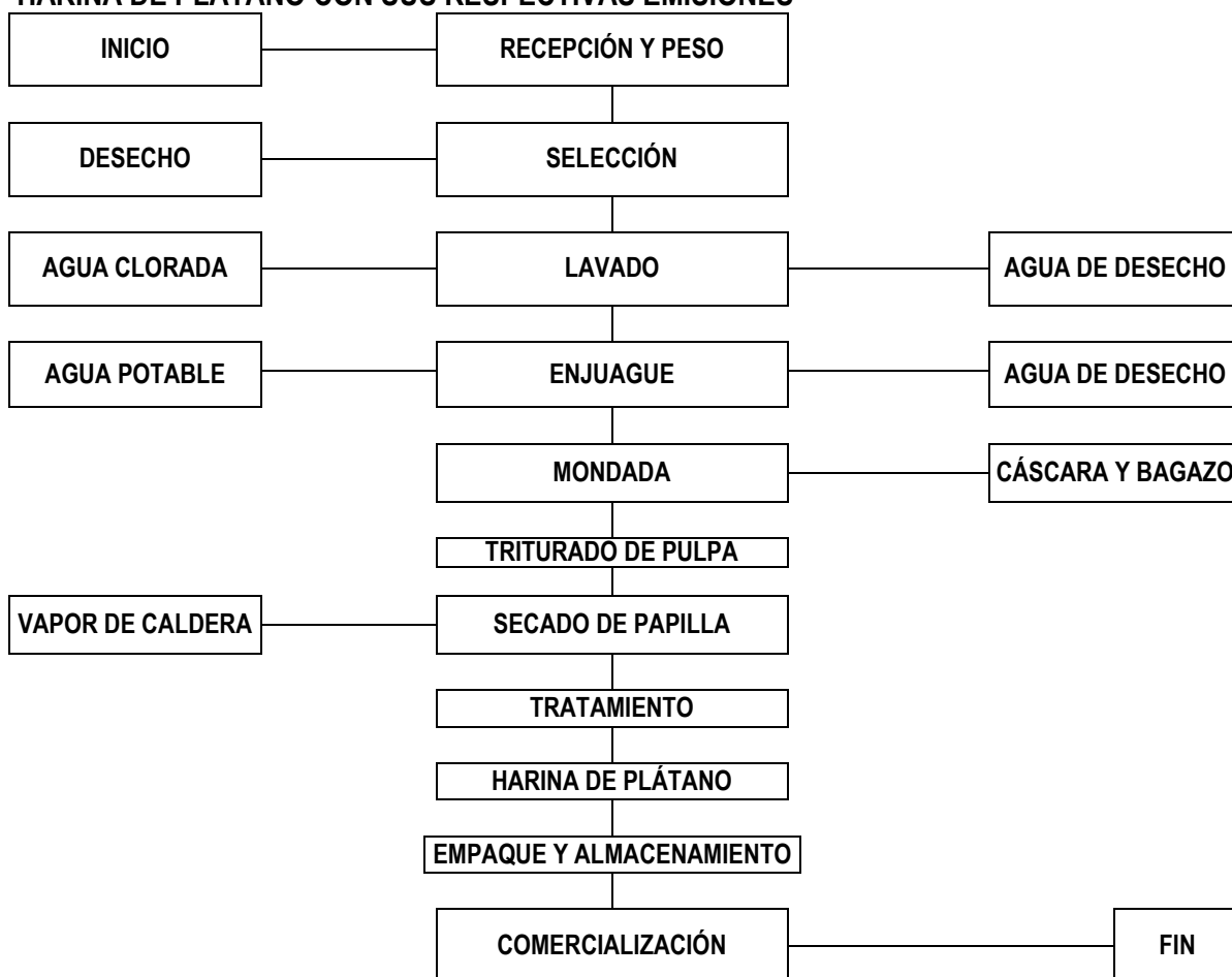
Gráfico 2 DIAGRAMA DE FLUJO PARA LA ELABORACIÓN Y COMERCIALIZACION DE HARINA DE PLÁTANO CON SUS RESPECTIVAS EMISIONES
