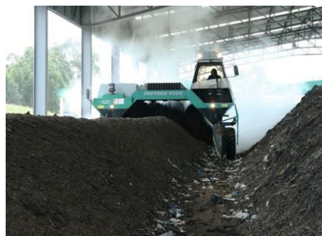
Pilas de Volteo Mecanizado
