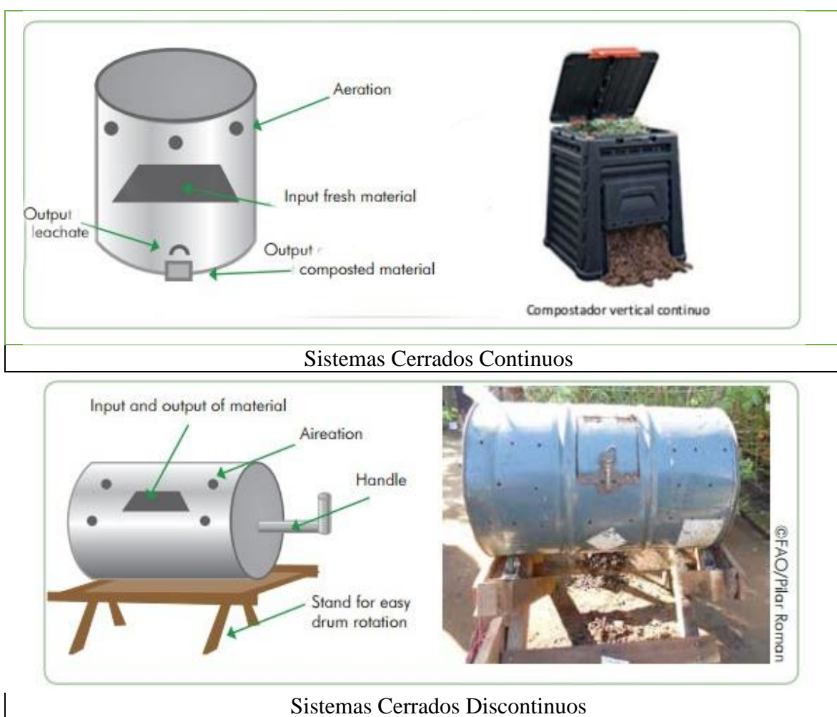
Figura 12. Sistemas cerrados de compostaje. Recuperado de Manual de compostaje del agricultor , por la FAO, 2013.
