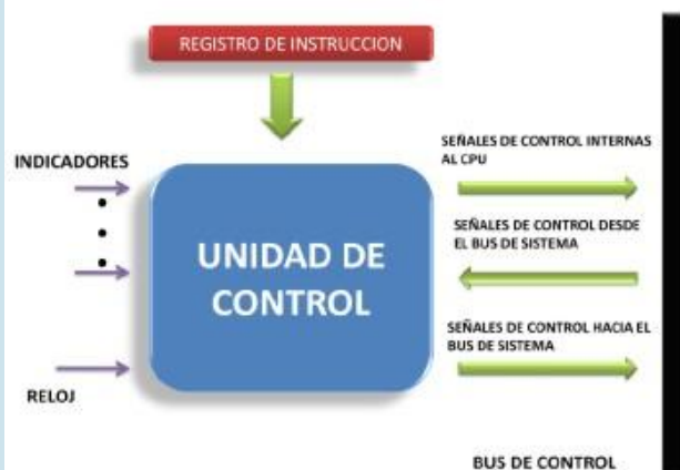
Figura 20. I/O en la Unidad de Control 23
