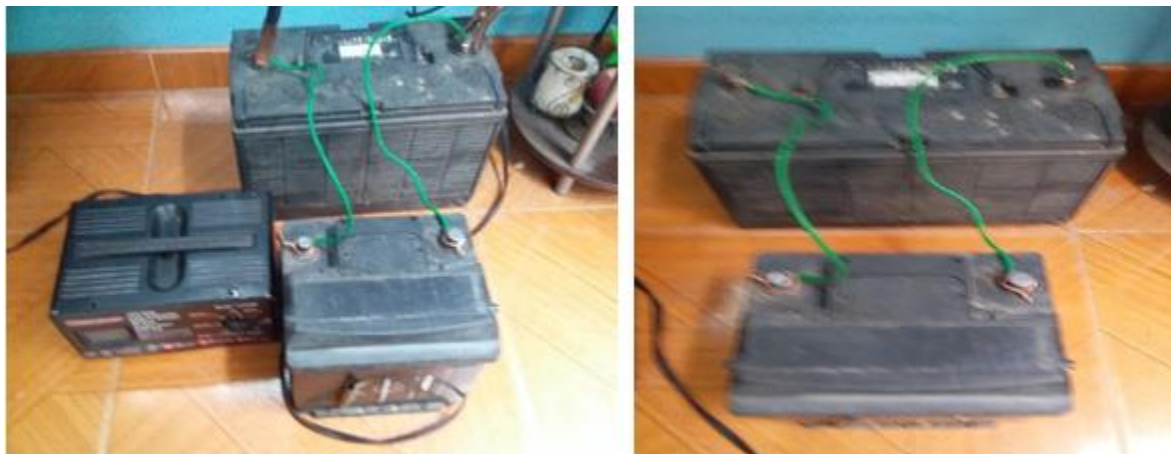
Figura 25 Conexión baterías serie con cargador. Fuente: Propia
