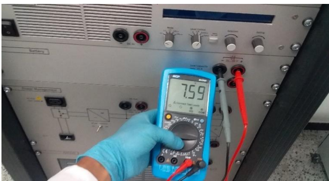
Figura 16 Voltaje de baterías después de 1 hora de conectar paneles directos. Fuente: Propia
