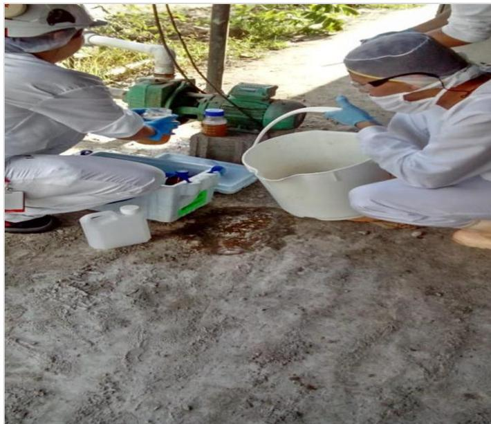
**Figura 8.** Toma de muestra simple en la bomba que conduce toda el agua residual de producción hasta los pozos de almacenamiento (Autores, 2018).
