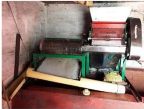
**Foto 8.** Despulpadora con zaranda. Fuente: Autor (2017).
